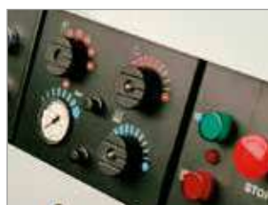
PANEL DE CONTROL CON APAGADO DE EMERGENCIA
